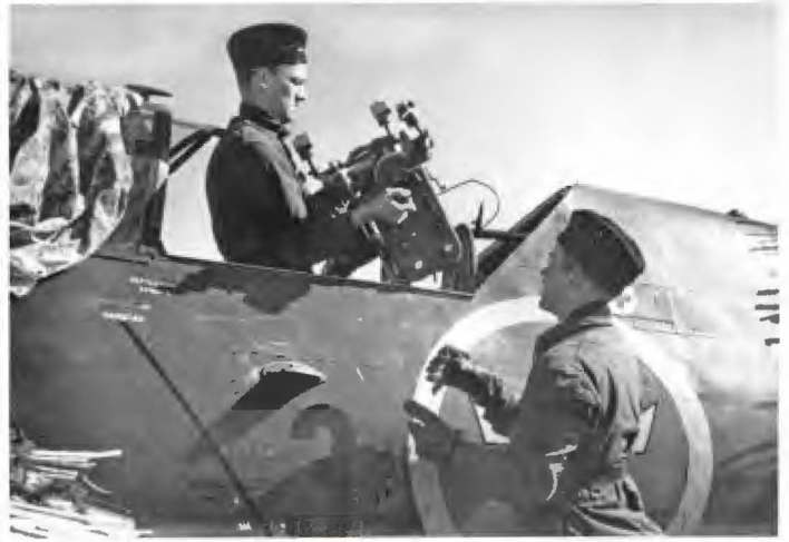
S 17B kunde utrustas med fast monterad kamera av äldre typ, men normalt gällde ögonspaning och användning av handkamera HK 5, HK 6 eller HK 7. Foto i Svensk Flyghistorisk Förenings arkiv.
